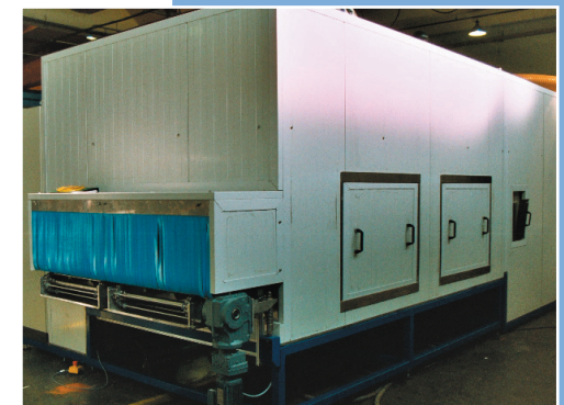
Auslaufbereich mit Schallschutz nach dem Trocknen
