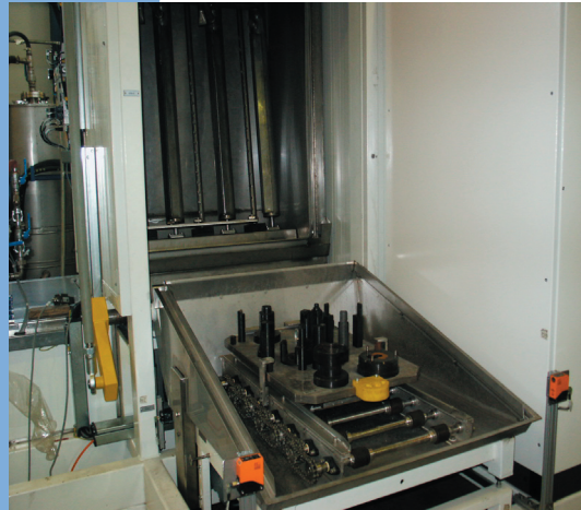
Werkstückträger mit Adaptern auf der Beschickungseinrichtung
