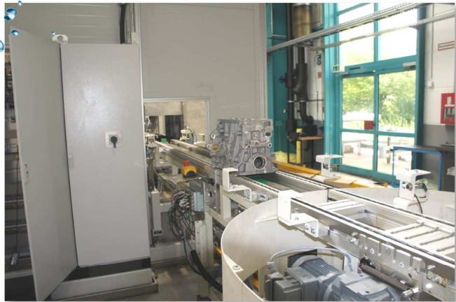
FlexCell mit Ab- und Zuführung über ein Förderband
